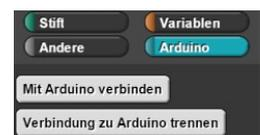
**Tipp:** Ab und zu trennt Snap4Arduino eigenständig die Verbindung zum Arduino und gibt eine entsprechende Meldung aus. Vor Test des Codes muss dann die Verbindung wieder erneuert werden.
