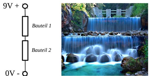
Das Wasser fließt zuerst durch den einen Wasserfall und anschließend durch den anderen. Das muss auch der Strom tun.
